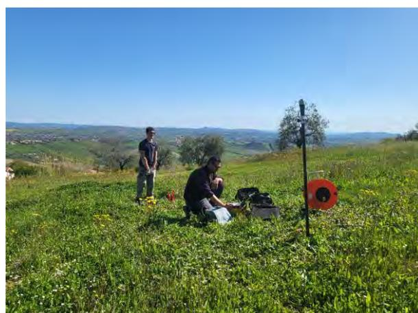
Fasi di acquisizione tomografia sismica 1-1'.
