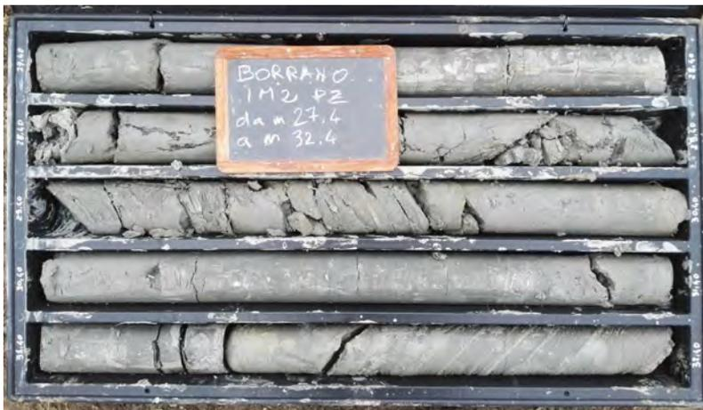
Carotaggio eseguito con carotiere T1, corona al widia duro Kal, con circolazione di fluido.
