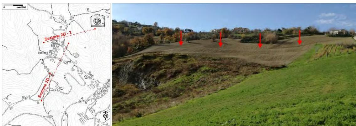
Figura 50 – Foto del versante orientale dell'abitato con chiari segni di deformazione.
