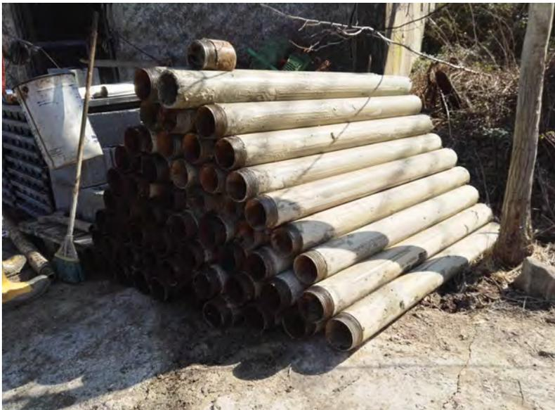
Tubi di rivestimento da 127 mm di diametro, impiegati per la stabilizzazione del foro.
