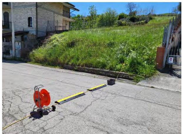
Fasi di acquisizione tomografia elettrica A-A' e B-B'.
