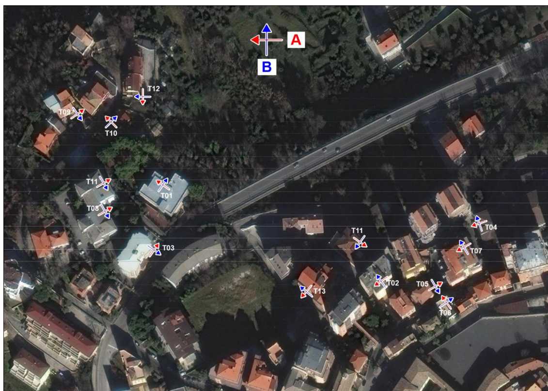
Figura 29 – Posizione degli assi di registrano per ogni tiltmetro.
