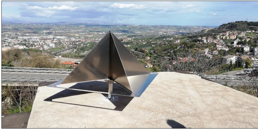
Figura 23 – Particolare dell'installazione del Corner Reflector in doppia orbita.
